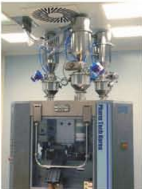
KVT16 , KVT25 Pnömatik yükleme ünitesi Pneumatic loader for Pharmaceutical industry
